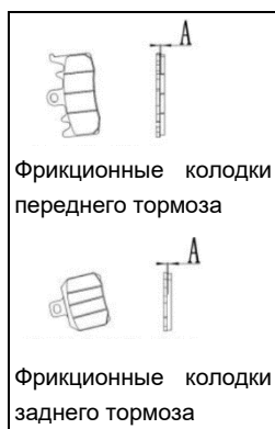
Рис. 26. Проверка фрикционных колодок переднего тормоза
