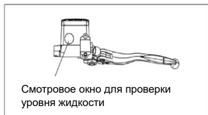
Рис. 31. Проверка уровня тормозной жидкости заднего тормоза
