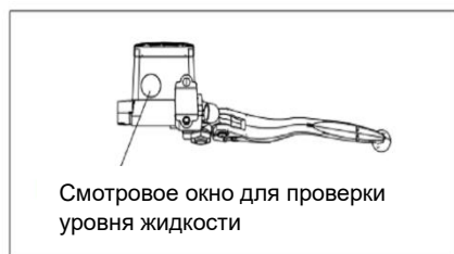
Рис. 27. Проверка уровня тормозной жидкости переднего тормоза
