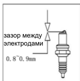
Рис. 24 Свечи зажигания
